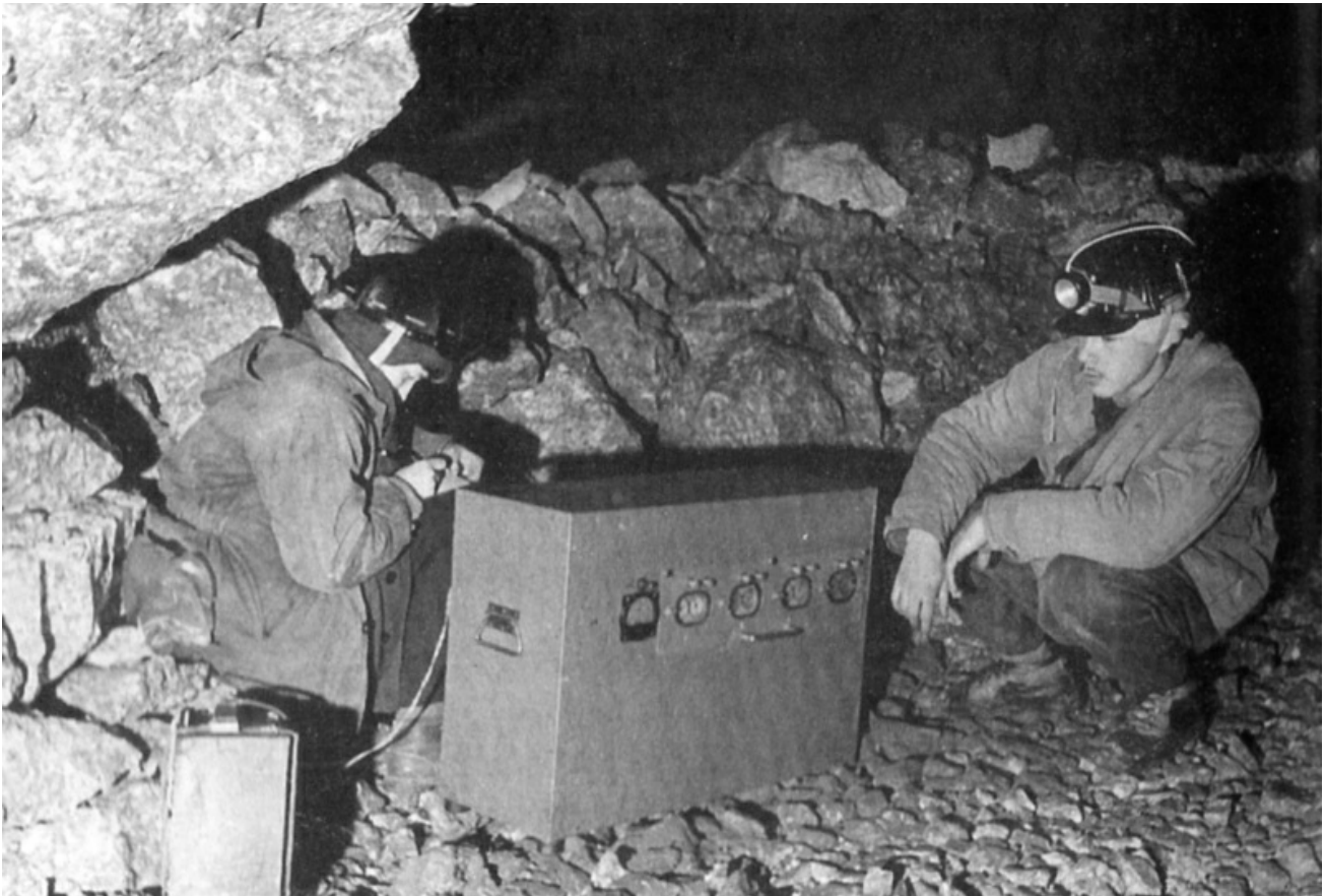
О.Г. и М.Г. Поповы на зимней студенческой практике работают с прибором, регистрирующем жесткое космическое излучение в Кунгурской пещере для оценки плотности пород и наличия пустот над ней. 1964 г.
